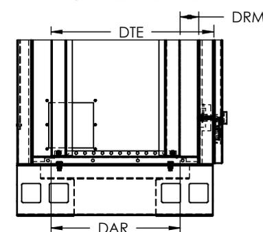
1. Fabricado en lámina galvanizada en frío calibre 18 y 16.
