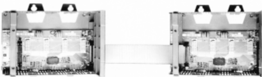
Deux racks reliés par câble (référence 1746-C7)
